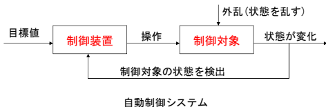
自動制御システム
